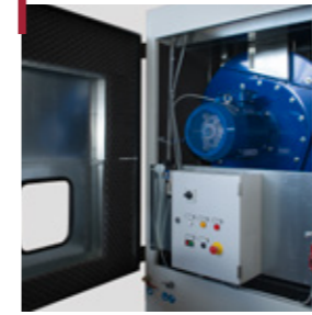
Elettro Ventilatore professionale in camera separata da unità filtrante. Completamente insonorizzato. Professional electro fan in a room separated from the filtering unit. Completely soundproof. Electro-ventilateur professionnel placé à l'intérieur de l'unité filtrante, dans une partie séparée. Insonorisation complète.
